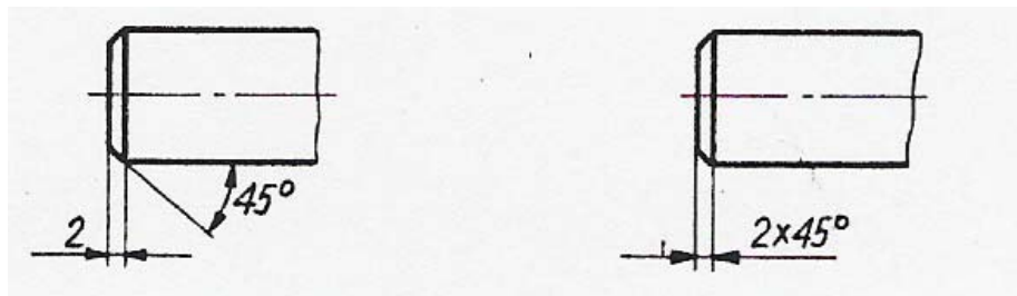
Rys. 4.6.6. Wymiarowanie ścięć krawędzi [6]
